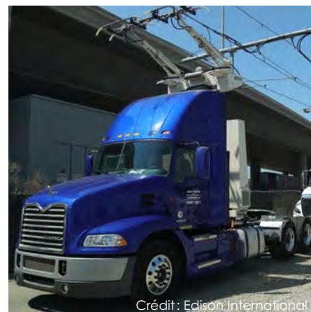
Figure 3-1 : Véhicules et recharge par caténaire pour un projet pilote en Californie
