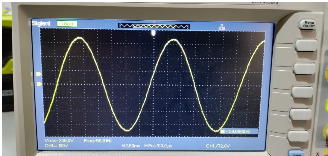
Figure 2 – Travaux sur la qualité d'onde du micro-réseau triphasé qui alimente la BRCC
