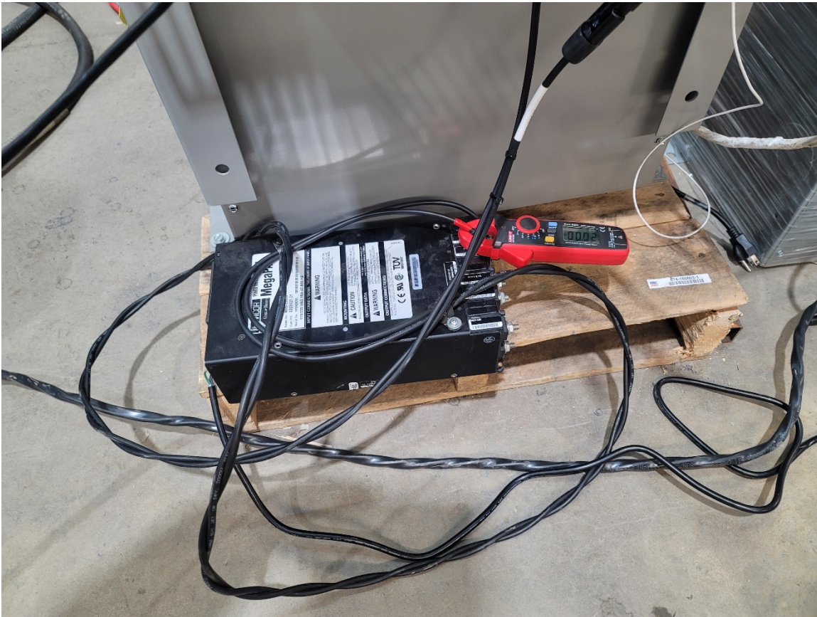
Figure 3 – Montage-prototype pour essais de « précharge » et essais des systèmes de contrôle critiques
