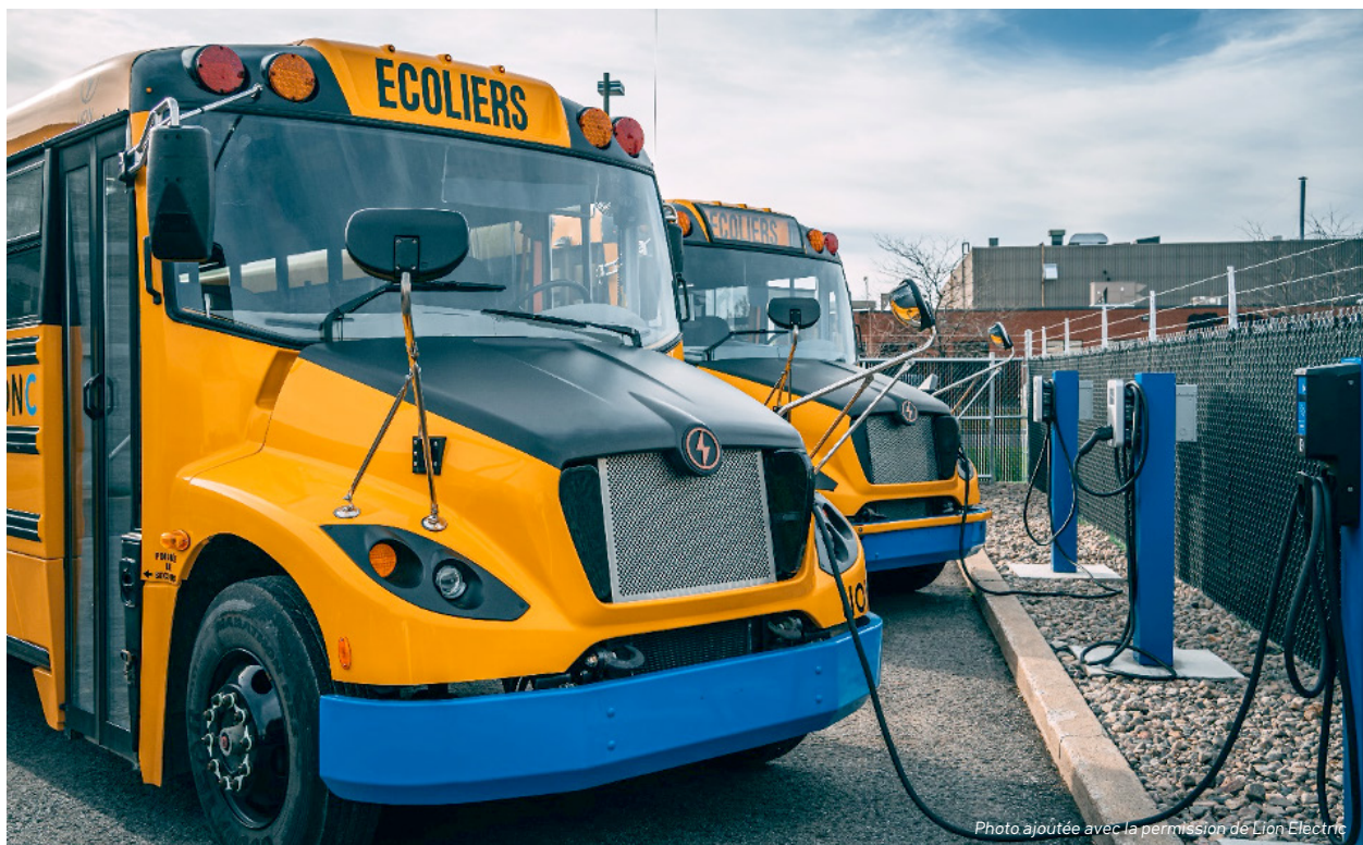
FIGURE 3 • Autobus électriques Lion rechargés par des bornes de recharge de niveau 2
